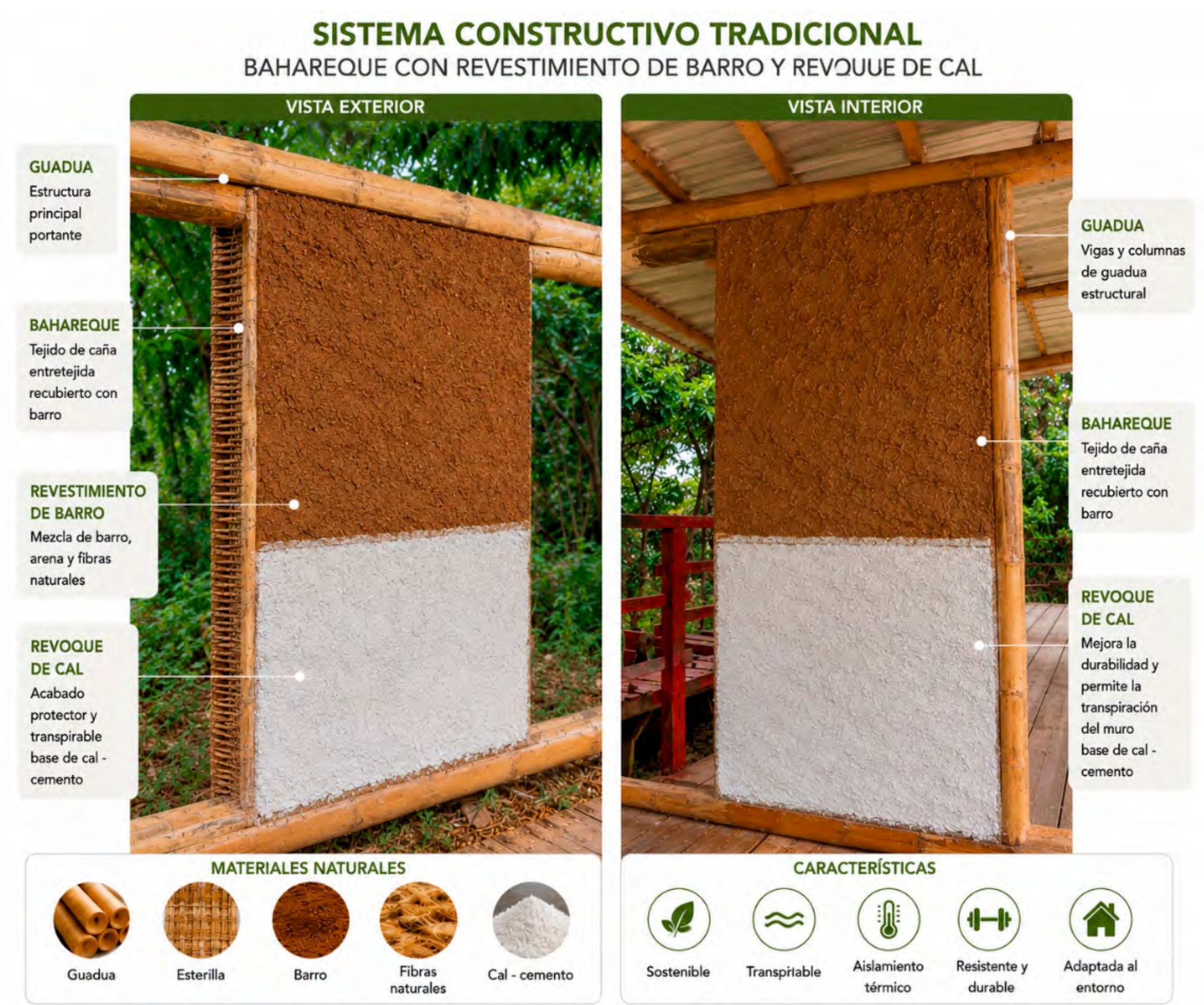
Figura 10 Módulo muro bahareque cemento-arena (ambos lados)
