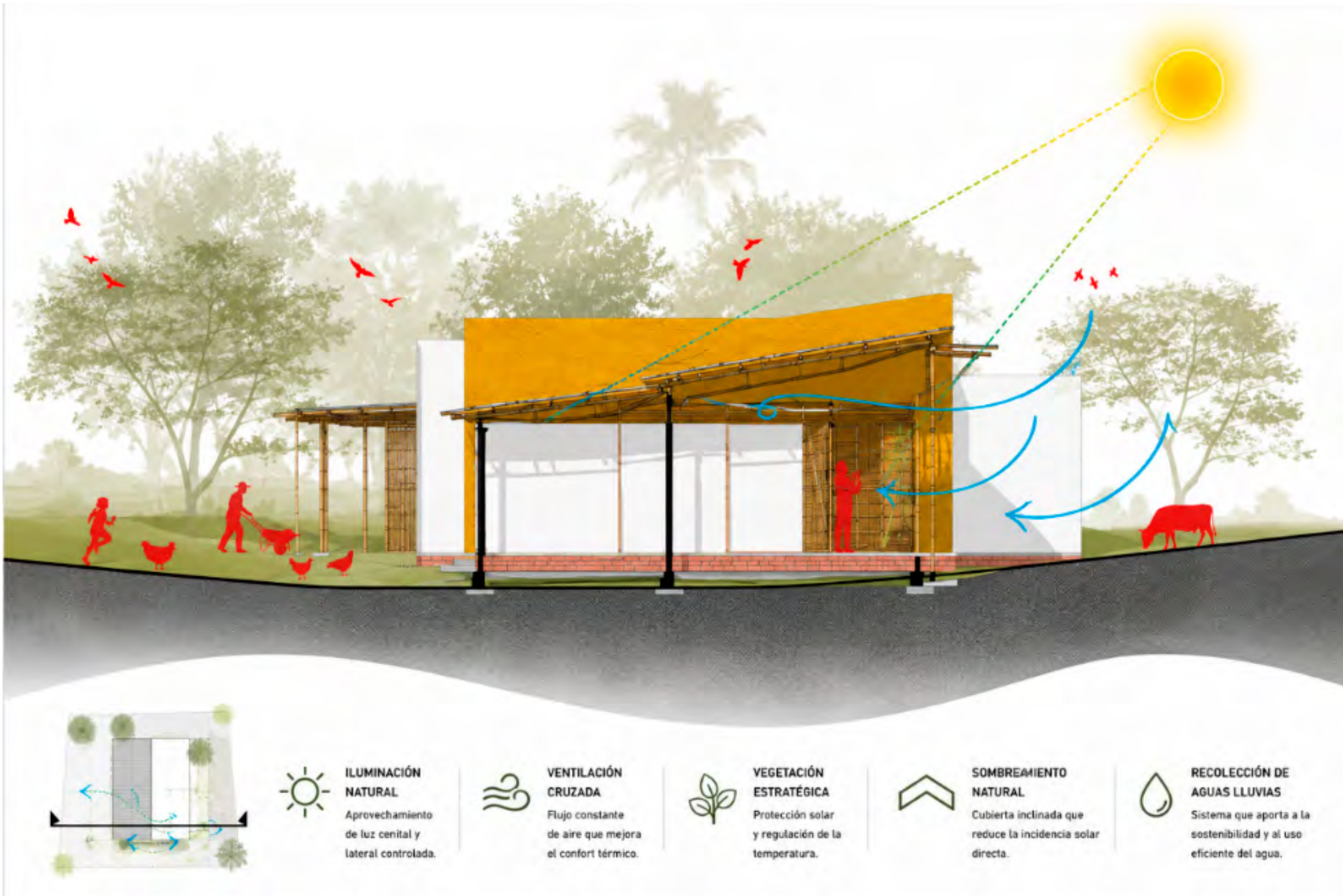
Figura 23 Estrategias bioclimáticas de iluminación y ventilación natural – Vivienda Picacho
