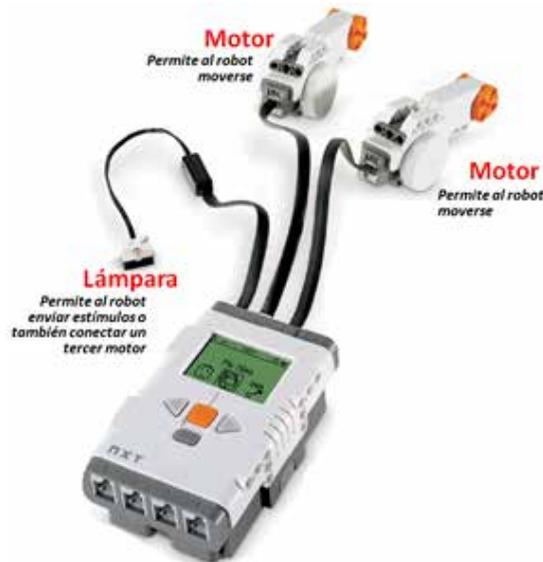
**Figura 7. Puertos de salida para conexión de motores y/o lámparas**
