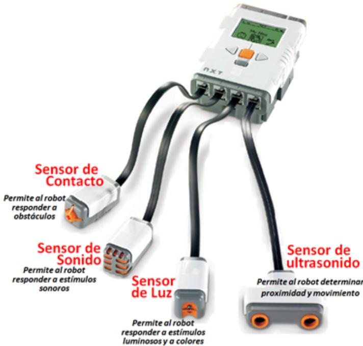
**Figura 6. Puertos de conexión de los sensores de las unidades NXT**
