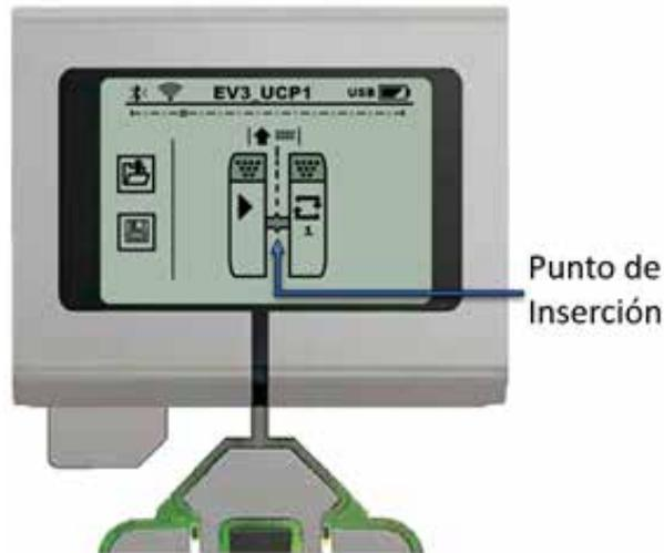
**Figura 38. Pantalla de inicio para la creación de un programa**
