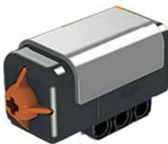
Figura 50. Sensor de presión o contacto unidad NXT
