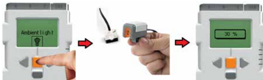
Figura 77. Funcionamiento de la Lámpara en las unidades NTX
