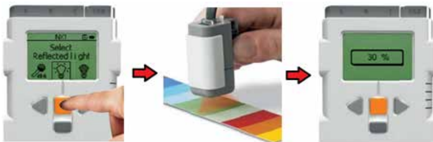
Figura 59. Configuración del sensor de luz para que mida luz reflejada
