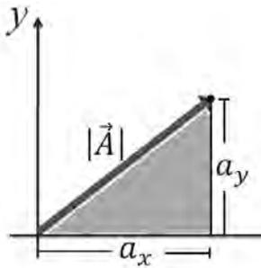
Figura 3.3. Magnitud y Dirección de un Vector. Fuente Propia.
