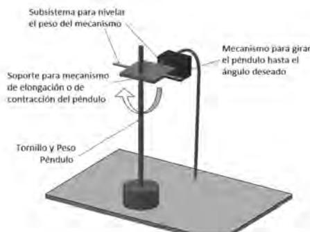
**Figura No.6.** Sistema de control del ángulo inicial. Equipo para verificar la ley de la conservación de la energía
