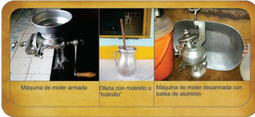
Figura 20. Máquina de moler y olleta con molinillo
