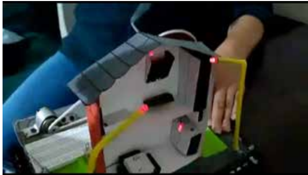
Fig. 9 Generador eléctrico de manivela suministrando energía a cuatro led.
