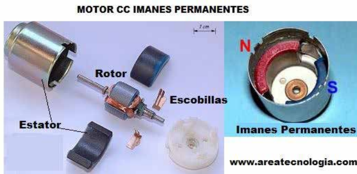
Fig. 11 Estructura interna de motor eléctrico [8]
