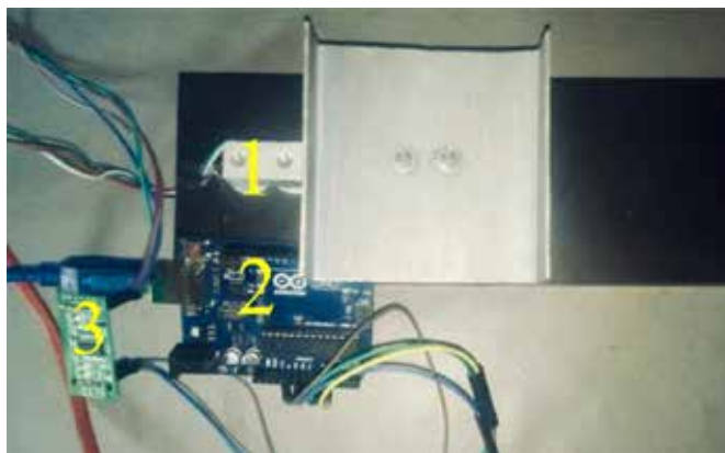
Figura 2. Montaje de la balanza controlada por Arduino . En detalle: la celda de carga (1), Microcontrolador Arduino Uno (2), y el Módulo HX-711 (3).
