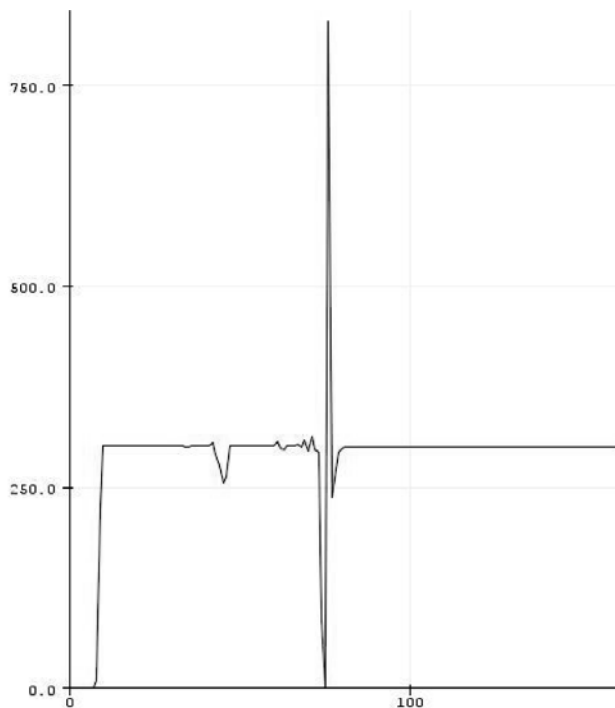
Figura 3. Masa del cuerpo (eje vertical) en función del tiempo (eje horizontal). Imágen obtenida del IDE de Arduino para una masa de 300\text{g} que golpea contra espuma de 4\text{ cm} de espesor.
