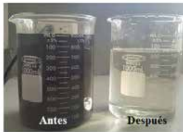
Fig. 9. A la izquierda muestra del tanque de homogenización antes del tratamiento y a la derecha muestra tratada con Fenton y sedimentada previamente
