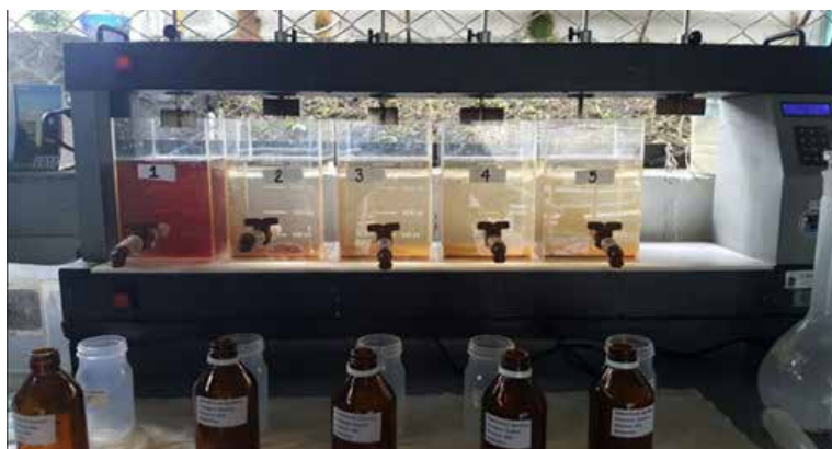
Fig. 1. Equipo de jarras usado para llevar a cabo la reacción
