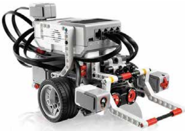
Fig. 3. Dispositivo Robótico LEGO MINDSTORMS configurado en modo tanque [17].
