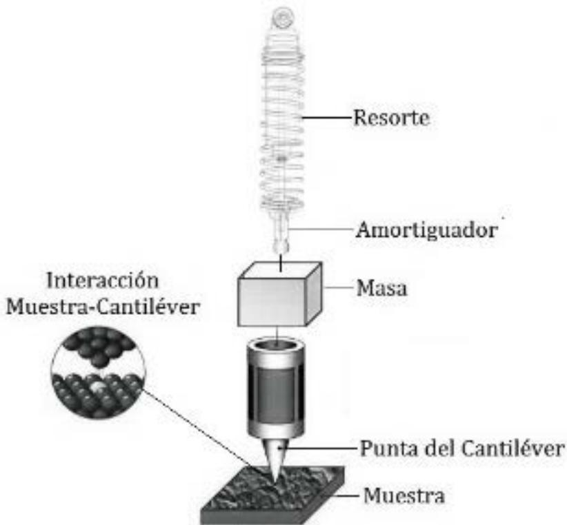
El AFM presenta una dinámica altamente no-lineal, por esta razón se deben determinar las regiones donde se puede tener control sobre el movimiento del cantiléver, con el propósito de mejorar la sensibilidad del instrumento, disminuir errores aleatorios e indirectamente mejorar la calidad de las medidas.
