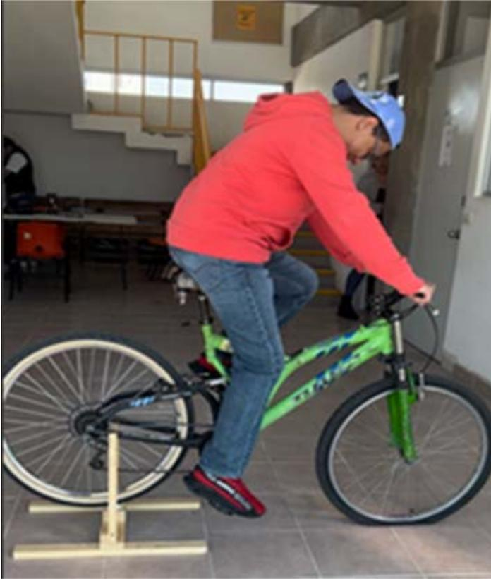
**Fig. 2. Alumno rodando la bicicleta, probando el prototipo**
