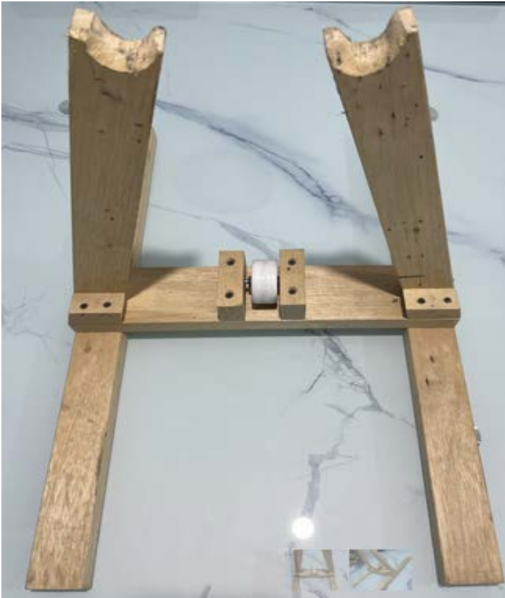
Fig. 1. Prototipo para usar en forma estática una bicicleta convencional
